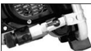
Alimentation d'eau ouverte (levier de vanne parallèle)
